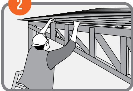
Colocación de placas onduladas de fibrocemento Perfil 4 atornilladas a los parantes de 38x38x0.45mm. con tornillos autorroscantes de 3" con arandela y capuchón.
