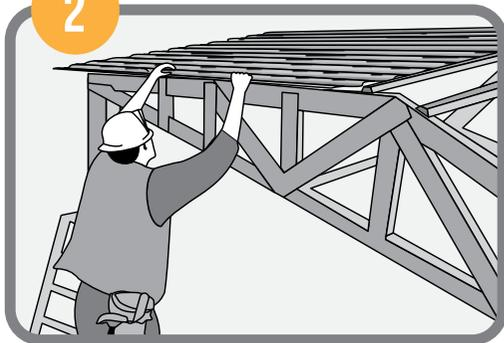
Colocación de placas onduladas de fibrocemento Perfil 4 atornilladas a los parantes de 38x38x0.45mm. con tornillos autorroscantes de 3" con arandela y capuchón. En la unión entre las placas se colocará una cumbrera fija.
