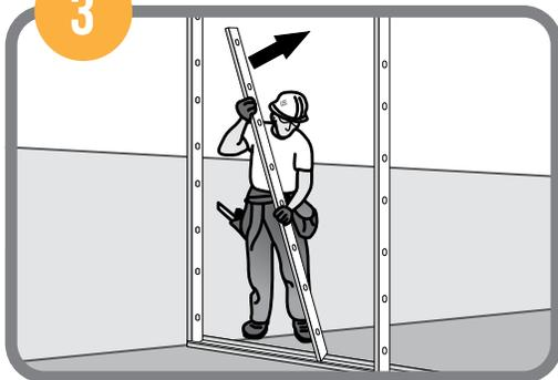
Continuando con los muros colocamos los parantes de 89x38, tipos C1, C2, C3 y C4, ver detalle de las Columnas C2 con dos parantes de 89x38x0.90mm. y conectores cada 0.81 con rieles de 90x0.40x0.90mm.
