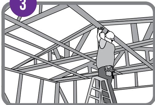
Colocación de parantes de 38x38x0.45mm. en la parte superior de los tijerales para instalar la cobertura de Perfil 4 (de acuerdo a plano) y luego instalar perfiles omega en la parte inferior de los tijerales, a cada 0.61ml. para colocar el falso cielo raso.
