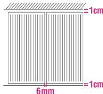
**Paso 3:** Con la ayuda de un atornillador fije la placa en las franjas lisas sobre los perfiles de acero galvanizado usando tornillos autoavellanantes 6x25mm punta fina o punta broca, considerando un distanciamiento de 25 a 30cm entre los tornillos.
