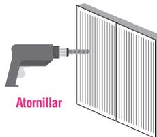
Asegure que las cabezas de los tornillos queden mínimo 1mm por debajo de la superficie.
